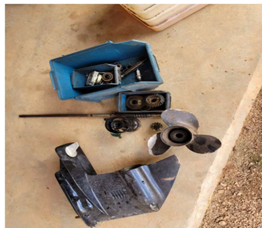
Foto 4: Reforma motor 40 peças trocadas
