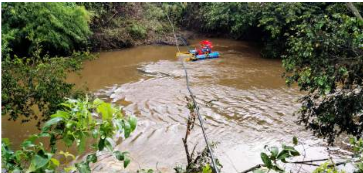
Imagem 100 (acima): balsa instalada. Observe o cabo de aço que cruza o rio por cima, e os cabos de aço que sustentam a balsa e a permitem subir e descer juntamente com a variação de nível das águas do rio. 13 fev. 2024.
