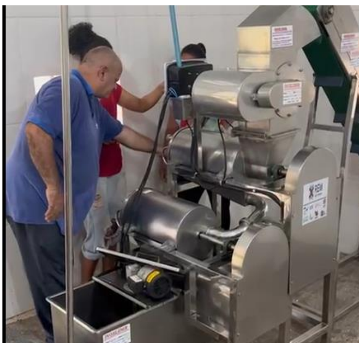
Figura 49. Treinamento de aferição, regulação e operação dos colaboradores no uso da trituradora/despulpadora, refinadora, equipamento da linha de processamento de frutas (Fonte: Arquivo da AGRIPAC) (26/02/2025).
