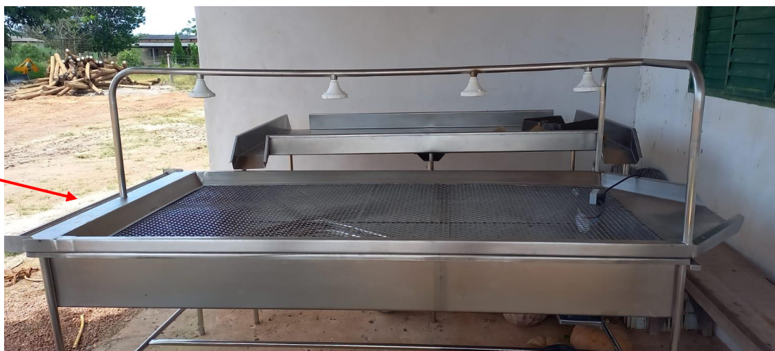
Figura 15. Mesa de lavagem para higienização de frutas por aspersão, em aço inox AISI 304, padrão alimentício (Fonte: Arquivo da Associação AGRIPAC) (17/07/2023).
