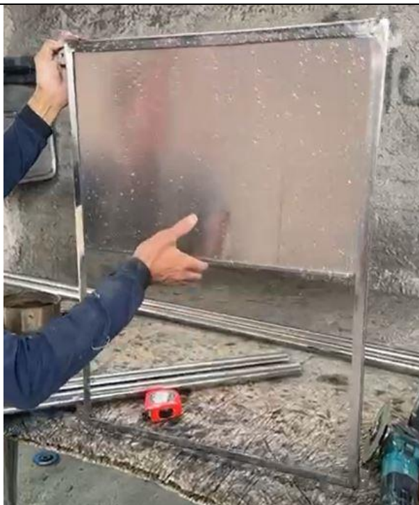
Figura 6. Óculo confeccionado em aço inox, para fechamento de abertura entre áreas da linha de produção (Fonte: Arquivo da AGRIPAC) (20/03/2025).
