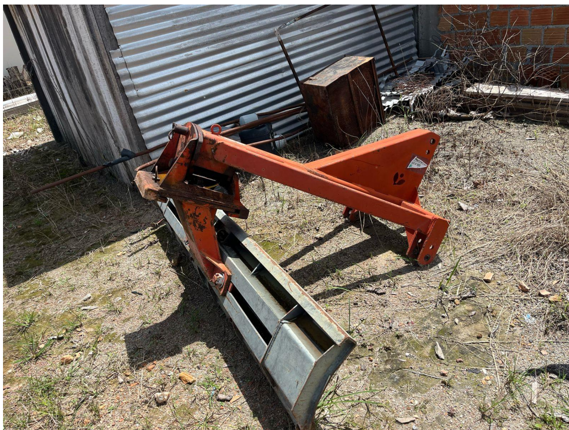
Figura 31. Plaina traseira hidráulica para trator, com lâmina de 1800 mm (Fonte: Arquivo da AGRIPAC) (13/03/2025).
