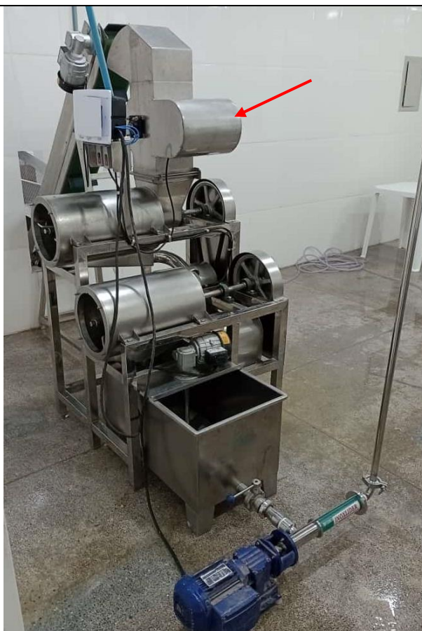
Figura 11. Despolpadora/trituradora/refinadora com capacidade de até 300 kg de fruta/hora (Fonte: Arquivo da Associação AGRIPAC) (17/07/2023).
