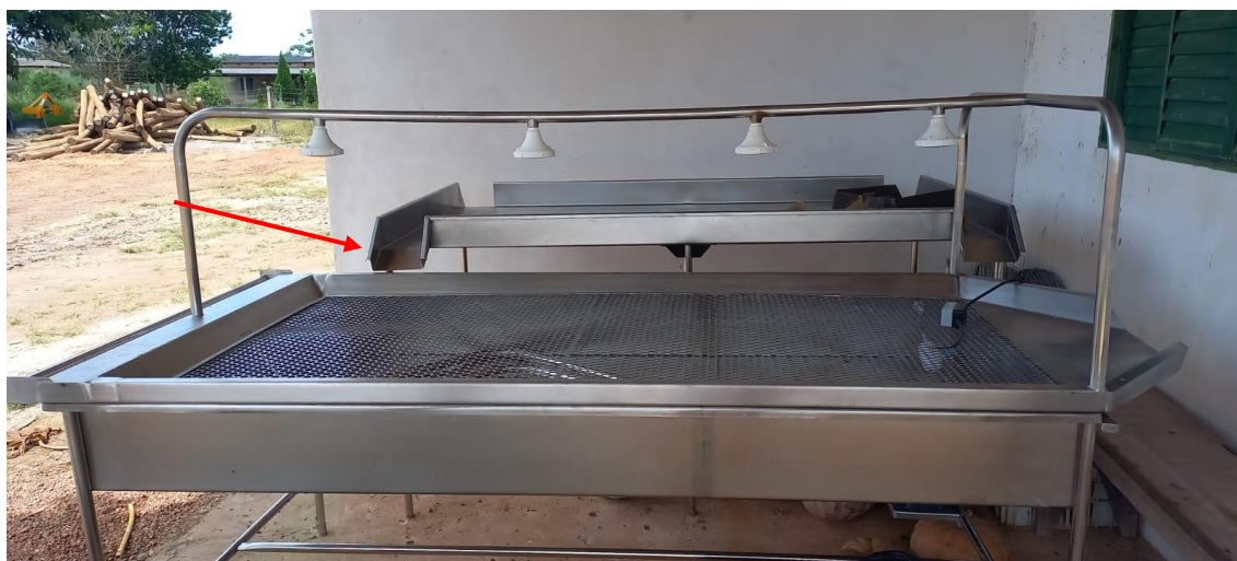
Figura 14. Mesa em aço inox AISI 304 polido, padrão alimentício, com 4 bicas de saída (Fonte: Arquivo da Associação AGRIPAC) (17/07/2023).
