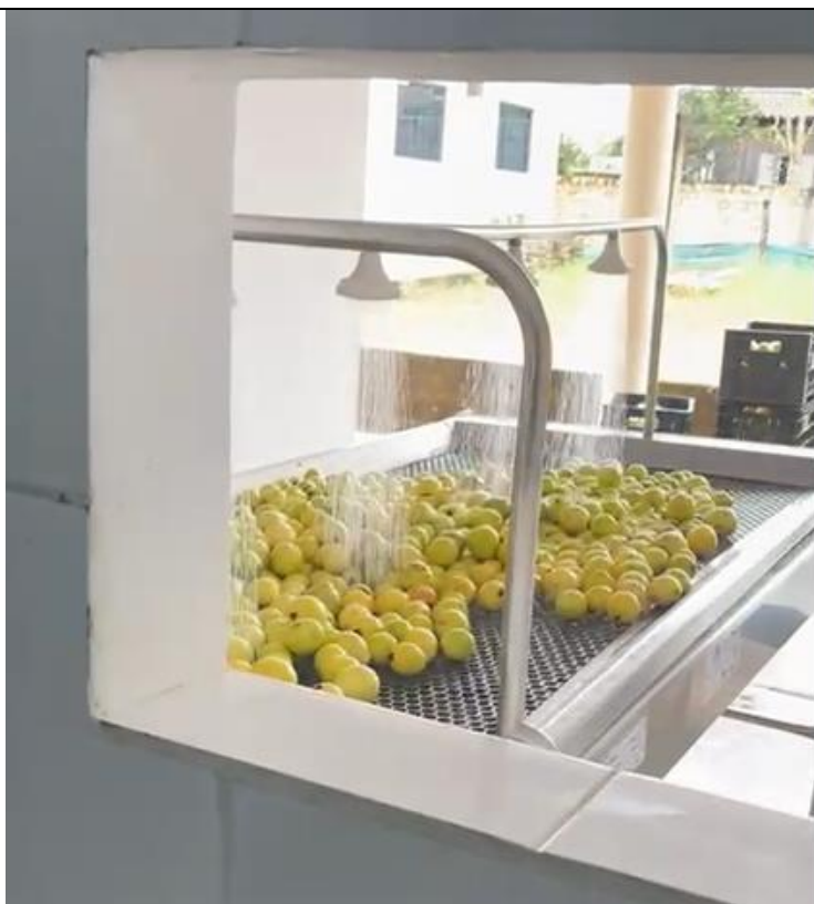
Figura 48. Visão, pelo óculo, no qual identifica frutas (goiabas) sendo higienizadas na mesa de lavagem, equipamentos da linha de processamento de frutas da agroindústria da associação (Fonte: Arquivo da AGRIPAC) (26/02/2025).
