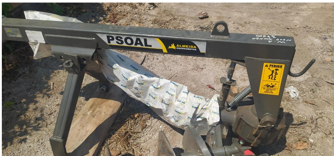
Figura 34. Perfurador de solo hidráulico com broca de 12" (Fonte: Arquivo da AGRIPAC) (16/09/2021).
