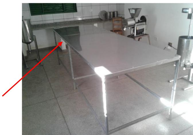
Figura 13. Mesa em aço inox AISI 304 polido, padrão alimentício (Fonte: Arquivo da Associação AGRIPAC) (17/07/2023).
