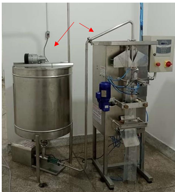
Figura 12. Tanque com mexedor e envasadora automática em aço INOX AISI - 304 (Fonte: Arquivo da Associação AGRIPAC) (17/07/2023).
