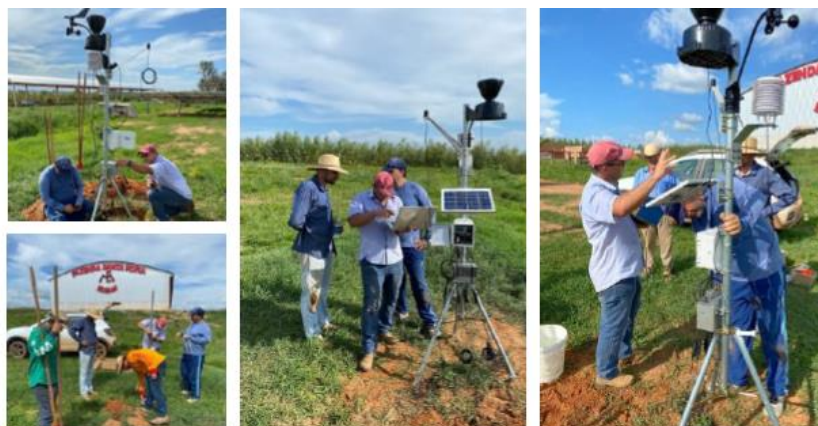
Figura 17: Instalação e aferição da estação meteorológica área experimental da UD, município de Juara (MT).
