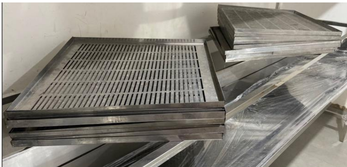
Figura 6. Bandejas de desidratação de amêndoas de castanha do Brasil da fábrica de beneficiamento da Terra Indígena Apiaká-Kaiaby. Juara-MT. Apoio Programa REM-MT.
