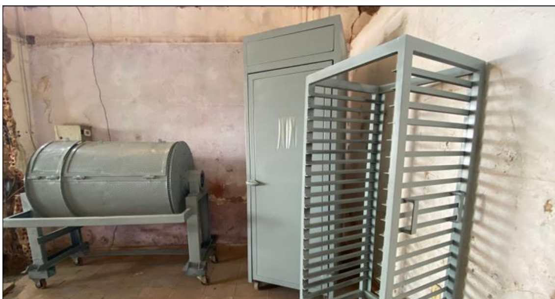
Figura 5. Secador rotativo e estufa de secagem da fábrica de beneficiamento de castanha do Brasil; Terra Indígena Apiaká-Kaiaby. Juara-MT. Apoio Programa REM-MT.
