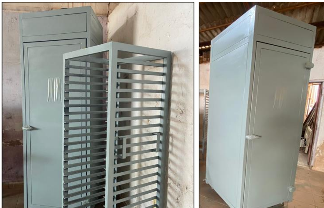
Figura 4. Estufa de secagem de castanha do Brasil da fábrica de beneficiamento de castanha do Brasil, da Terra Indígena Apiaká-Kaiaby. Juara-MT. Apoio Programa REM-MT.
