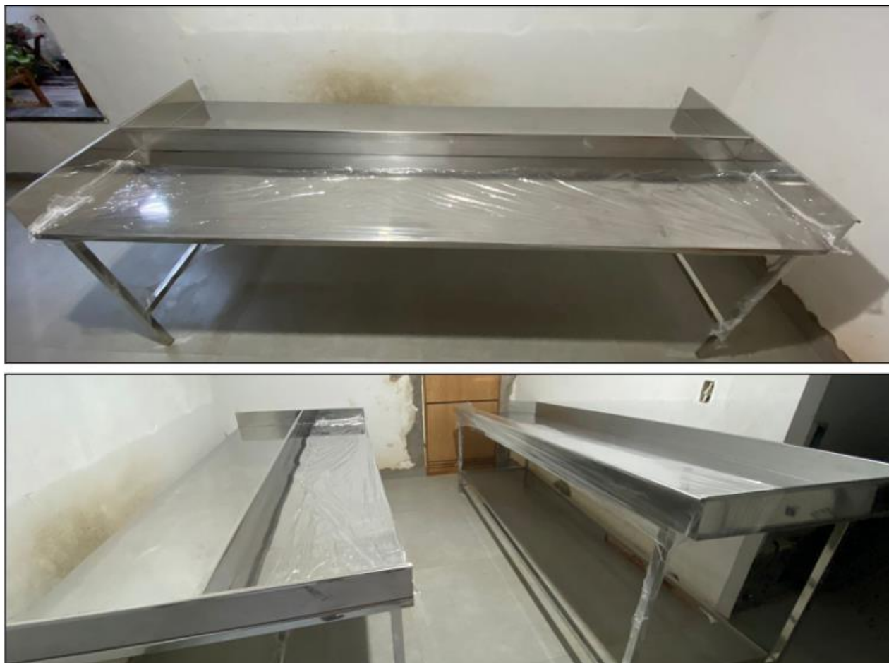
Figura 8. Mesas de classificação e separação de impurezas da fábrica de beneficiamento de castanha-do-Brasil da Terra Indígena Apiaká-Kaiaby. Juara-MT. Apoio Programa REM-MT.
